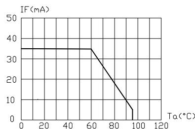
FIG.5 MAXIMUM FORWARD CURRENT VS. AMBIENT TEMPERATURE( $T_{jmax}=120^{\circ}\text{C}$ )
